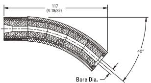
**2" Coarse Thread Blast Nozzles**
